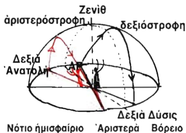
Σχ. 36. Δεξιόστροφη κίνηση ἡλίου στὸ Β. ἡμισ., ἀντίθετη στὸ Νότιο.
