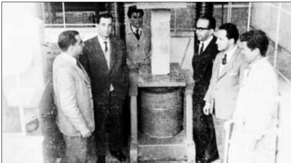
Έργαστηριακό πιεστήριο (πρέσα) των 500 τόννων όλικού φορτίου. (Φωτογραφία του 1958.) Διακρίνονται: 1. Ο προϊστάμενος του Έργαστηρίου Ε. Ευσταθιάδης (2ος από αριστερά) με συνεργάτες του τους: 2) Ν. Πλευριτάκη, πολ. μηχανικό, 3) Νικ. Δουδλέτη, χημ. μηχανικό, 4) Γεώργιο Λαμπρινάκη - Ν. Αναγνωστόπουλο και Καλλέργη, από το βοηθητικό τεχνικό εργαστηριακό προσωπικό.
