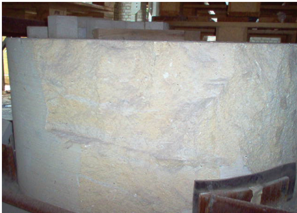
Όμοίωμα σπονδύλου, όπου εφαρμόστηκε το πείραμα με τους τεχνητούς σεισμούς.
