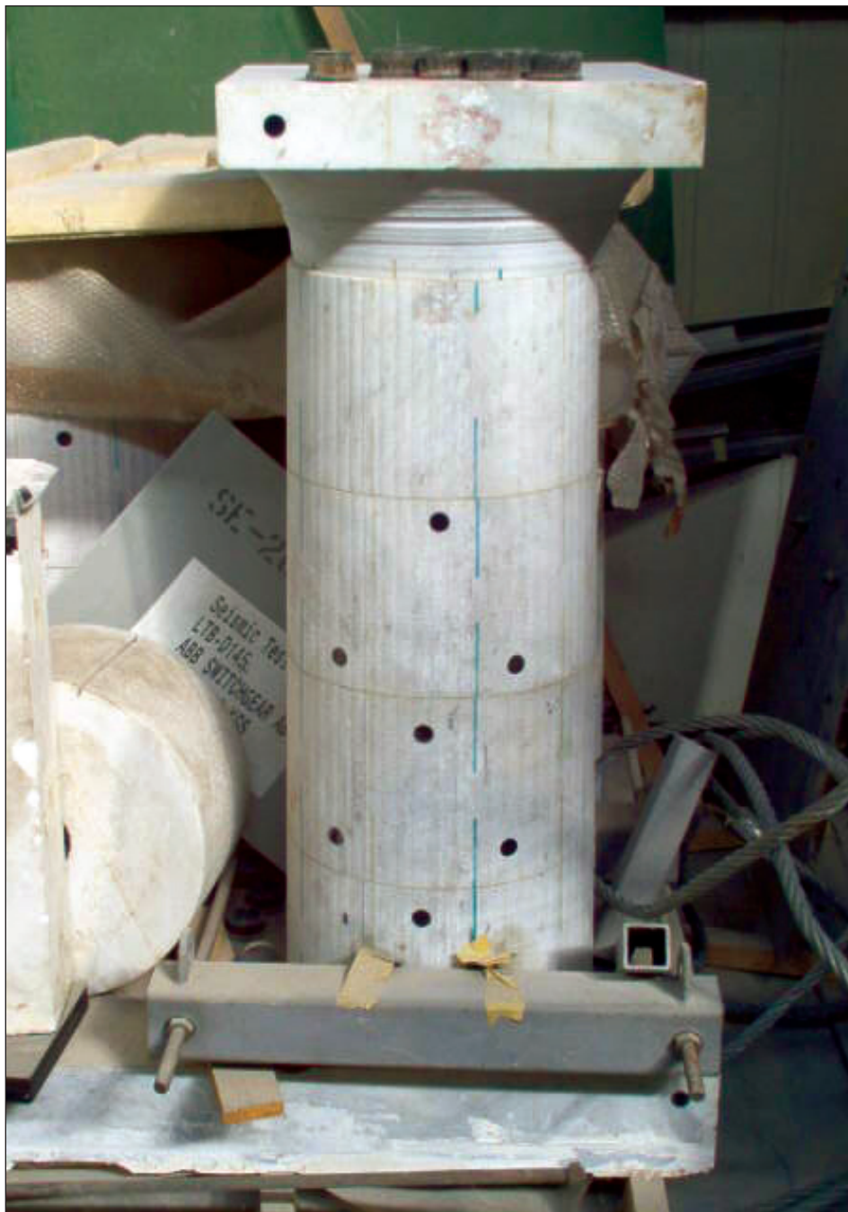
Όμοίωμα κίονος της Έπιδαύρου, στο οποίο εφαρμόζεται το πείραμα με την πρόκληση τεχνητού σεισμού.
